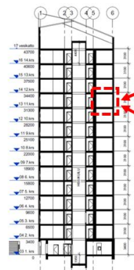
A-luokan kantavat rakenteet, R120
