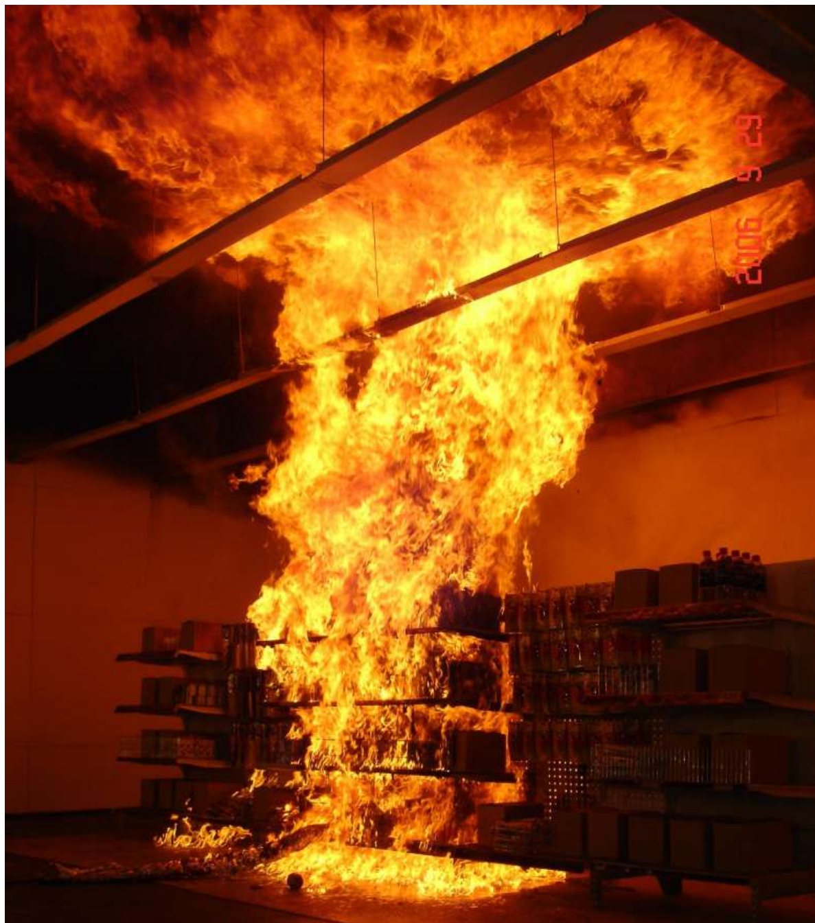
Kuva 22. Ruotsalaistutkimuksen yhteydessä tehty myymälähyllyn polttokoe (Kuva: Magnus Arvidson, SP Sveriges Tekniska Forskningsinstitut)
